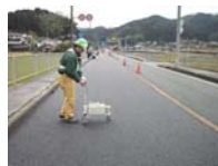
わだち掘れ量調査
